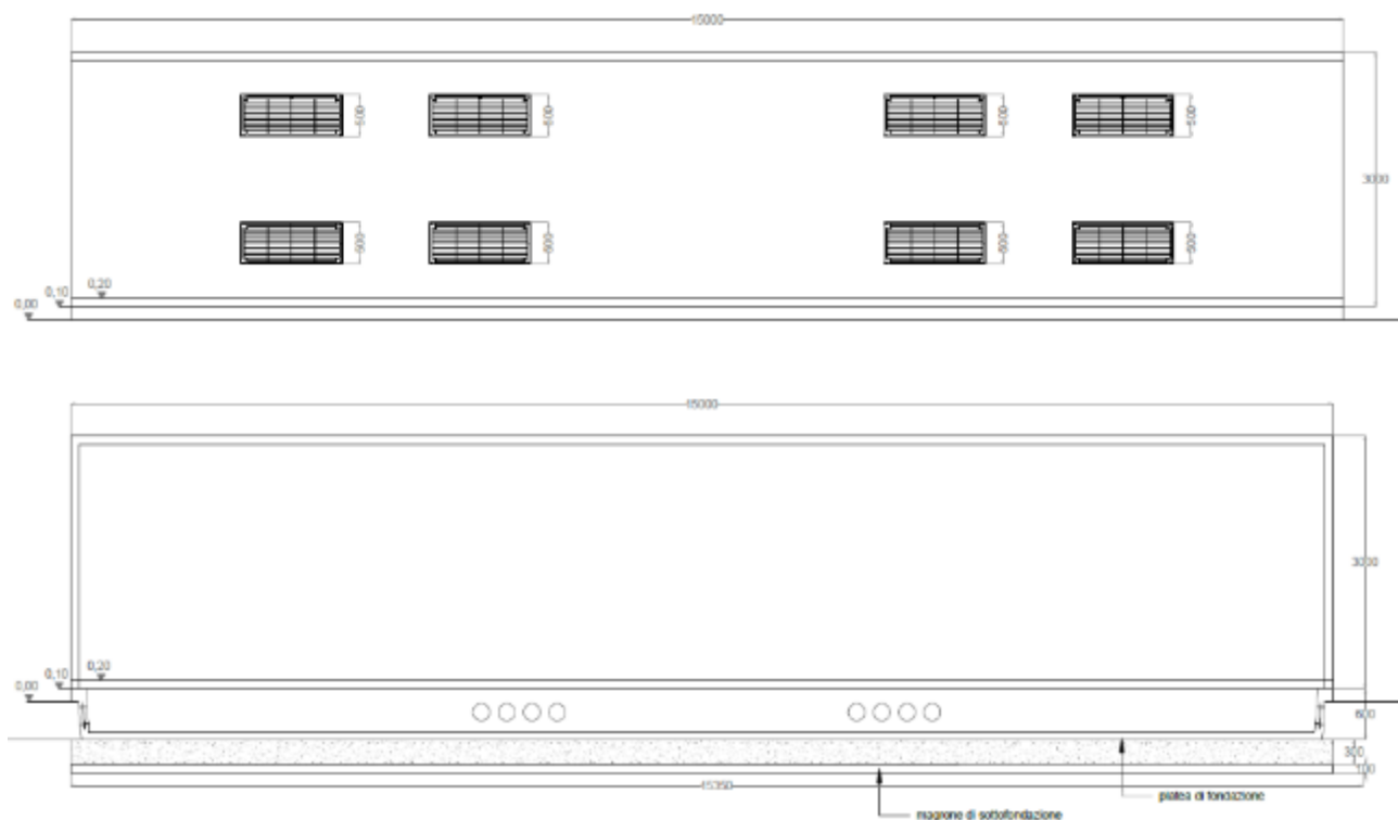
Figura 2-4 prospetto e sezione della cabina di consegna
